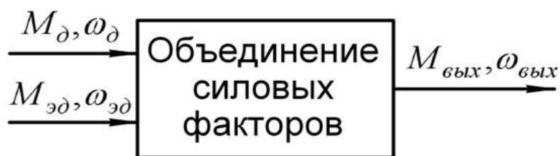
Рис.4. Обобщенная схема СУ с двумя входами от ДВС и ЭД.
