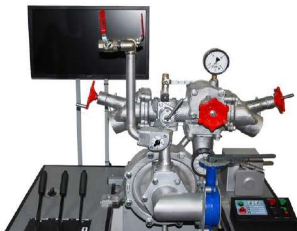
Рис. 1. Универсальный интерактивный учебно-тренировочный комплекс средств тушения пожара «УТК-ТП».
