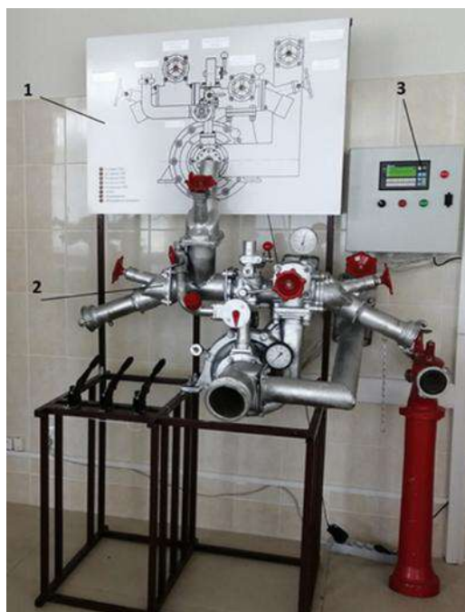
Рис. 6. Тренажер «Пожарный насос».
