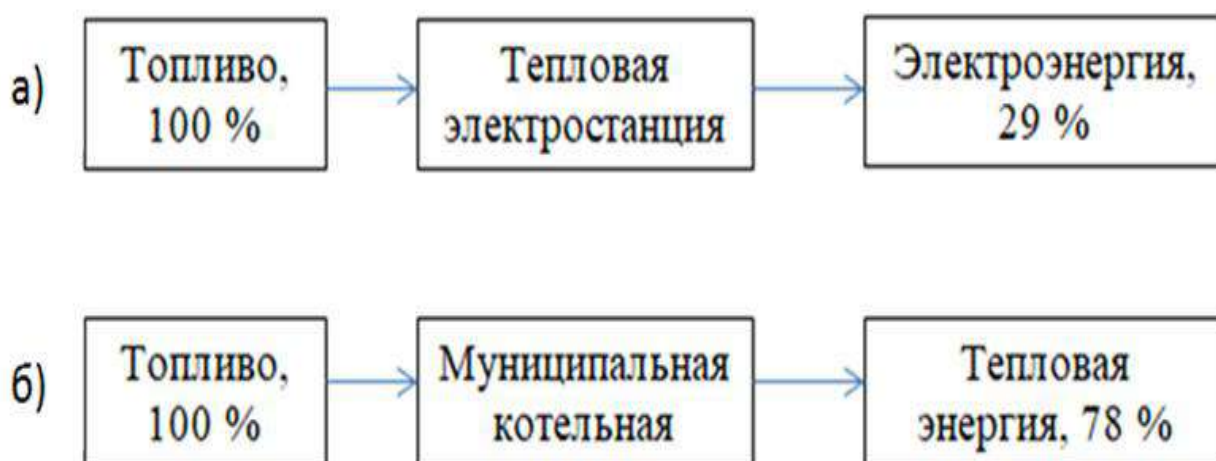
Рис. 1. Раздельное производство электроэнергии и тепла.
