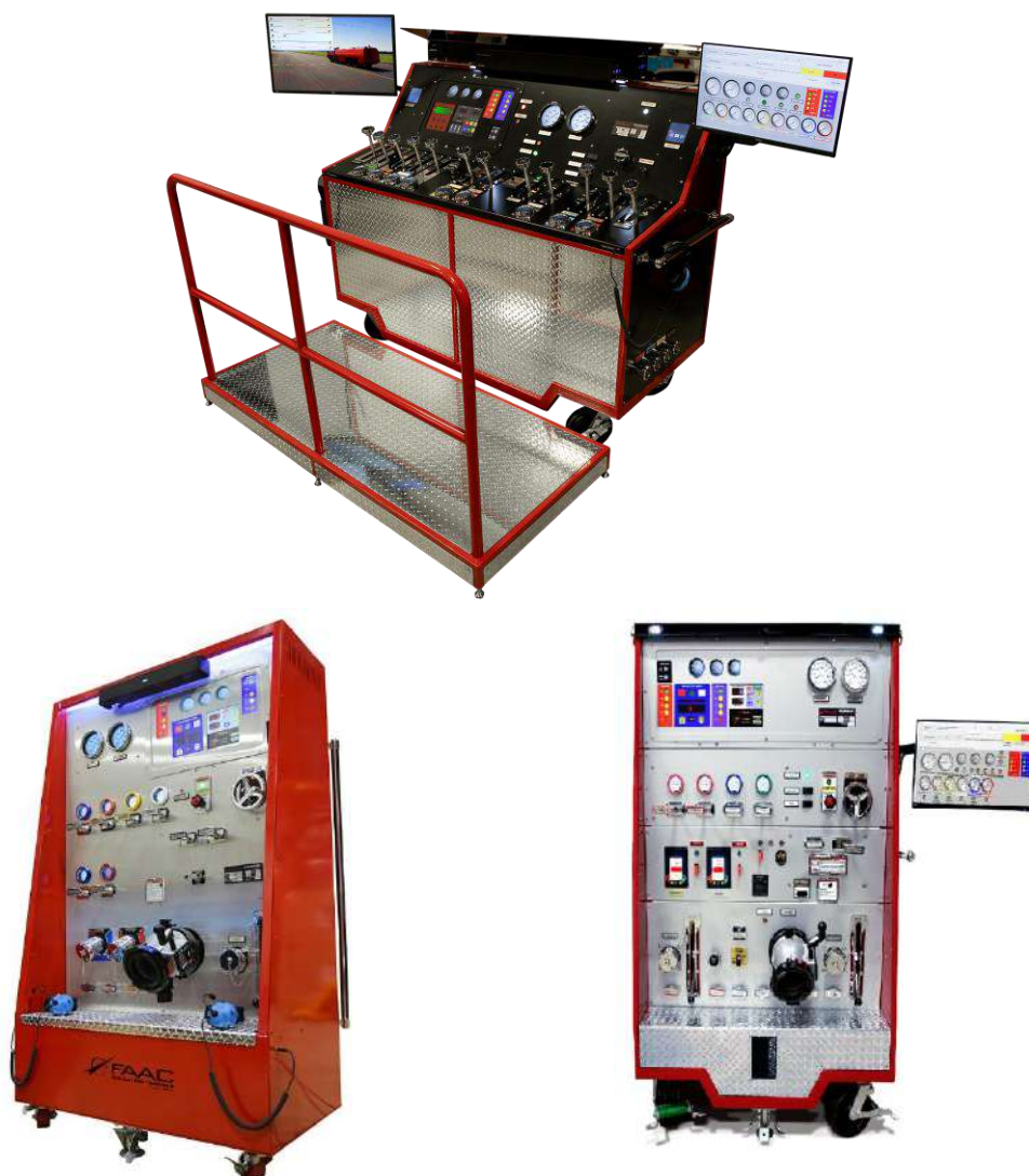
Рис. 9. Тренажерный комплекс FIRE PUMP OPERATOR SIMULATION TRAINING.
