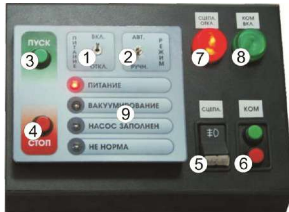
Рис. 4. Органы управления автомобиля и насосного отсека.
