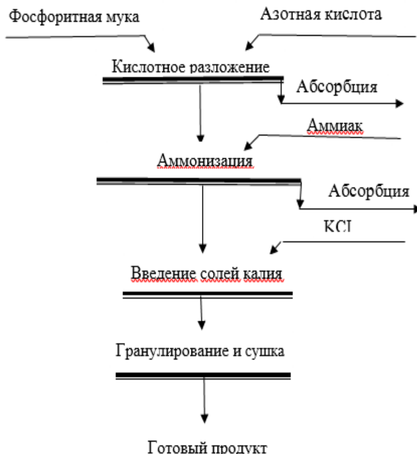
Рис. 6. Принципиальная технологическая схема получения NPK-удобрения.
